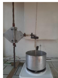
Рисунок 2.5 – Установка для измерения температуры горения: а) термопары для измерения, б) реактор с термопарами
