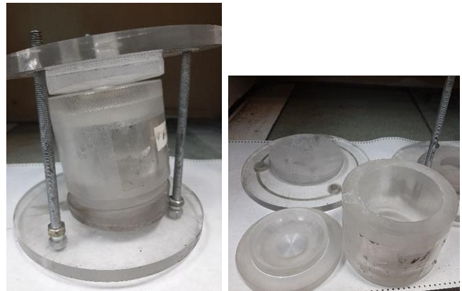
Рисунок 2.3 - Мельницы из полиакрилата
