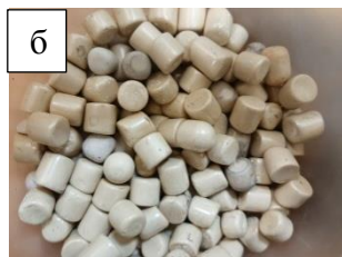
Рисунок 2.4 – Мелящие тела: а) цилиндры, б-г) циркониевые шары
