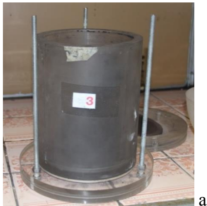
Рисунок 2.2 - Нестандартные мельницы для помола крупных партий NMC-111
