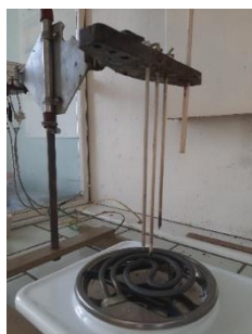
Рисунок 2.5 – Установка для измерения температуры горения: а) термопары для измерения, б) реактор с термопарами
