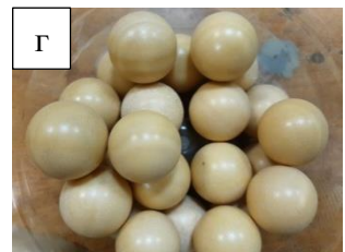
Рисунок 2.4 – Мелящие тела: а) цилиндры, б-г) циркониевые шары
