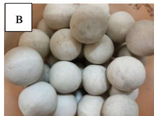
Рисунок 2.4 – Мелящие тела: а) цилиндры, б-г) циркониевые шары
