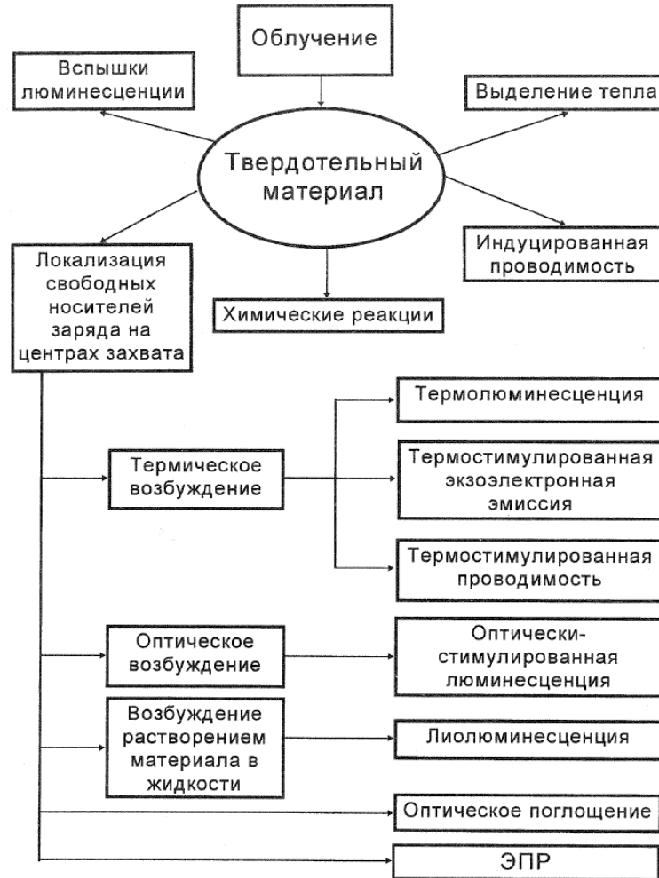
Рисунок 1.1 – Классификация люминесцентных методов дозиметрии [10]
