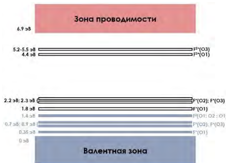
Рисунок 3.9 – Схема энергетических уровней дефектов в запрещенной зоне \text{LiMgPO}_4
