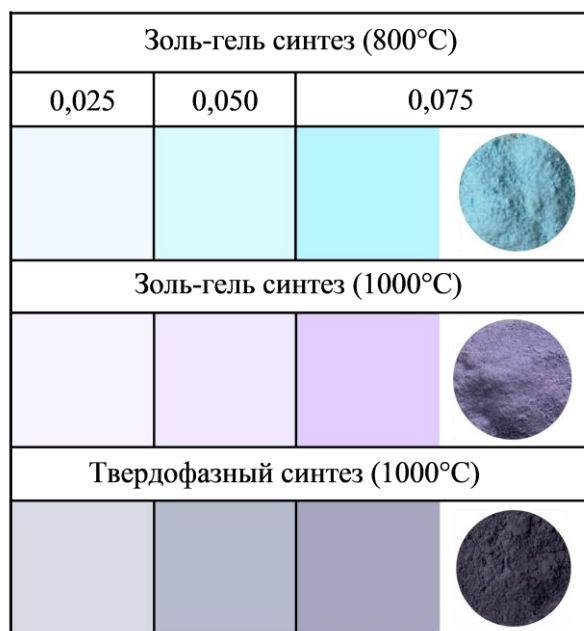
Рисунок 3.14 – Цветовая окраска твердого раствора \text{Zn}_{2-2x}\text{Cu}_{2x}\text{SiO}_4 , полученного твердофазным и золь-гель методами
