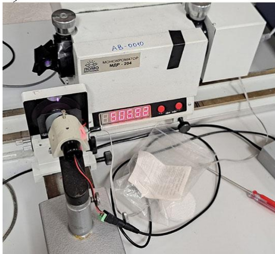
Рисунок 2.3 а) Схема конвертации модульного спектрометра для снятия спектров фотолюминесценции в ИК диапазоне. 1 – лазерный диод 808 нм ( P = 200\text{ мВт} ) с 4-х лепестковым модулятором и фотодатчик синхродетектора, 2 – кюветное отделение, либо термостат с кюветой, 3 – образец, 4 – монохроматор МДР-204 с дифракционной решеткой 1200 штр./мм, 5 – детектор ФПУ PbS, 6 – оптическая скамья, ПК-портативный компьютер, 7 – широкополосный германиевый фильтр; б) Фото конфигурации спектрофлуориметра для измерений в ИК диапазоне длин
