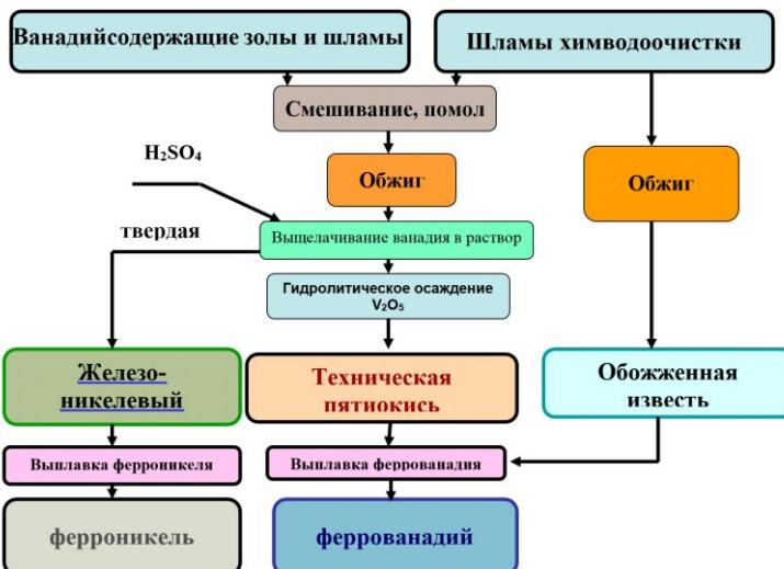
Рис. 2. Принципиальная технологическая схема комплексной переработки зол и шламов тепловых электростанций
