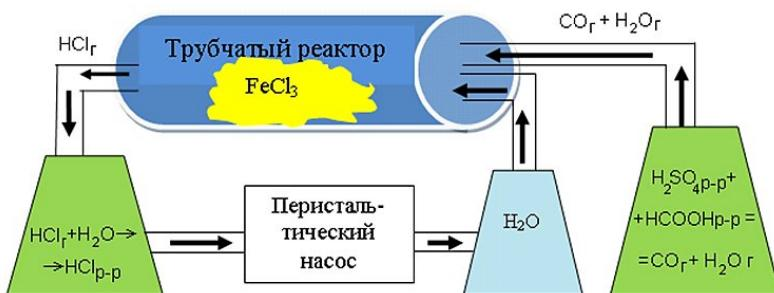
Рис. 2. Схема 2 установки для получения ультрадисперсных порошков металлов методом термогидролиза при внешней подаче газа-восстановителя
