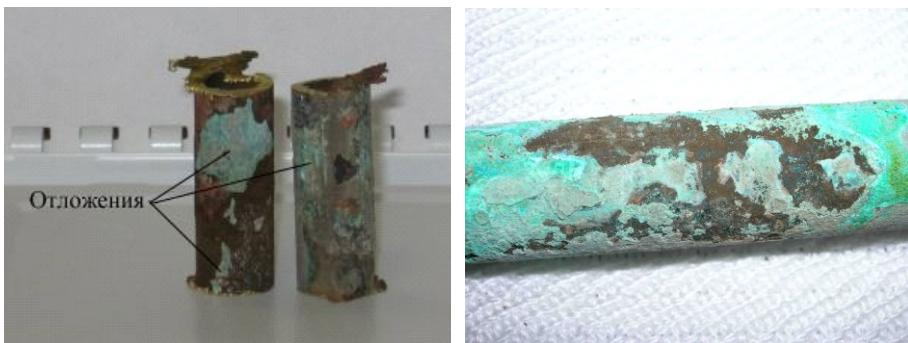
Рис. 1. Отложения с высоким содержанием меди на поверхности образцов теплообменных труб из выпарных аппаратов
