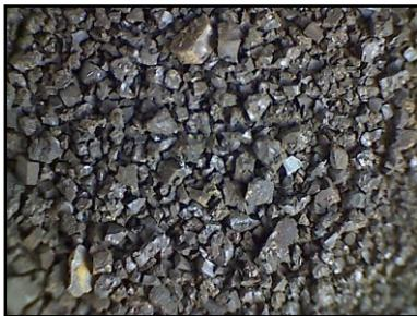
Рис. 3. Гидратированная пятиокись ванадия (после просушки при 80 °C), полученная в одном из опытов (увеличение в 20 раз)
