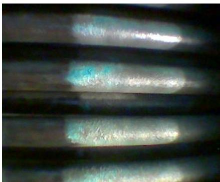
Рис. 4. Термообменные трубы промышленного выпарного аппарата, покрытые отложениями с высоким содержанием меди, до проведения химической очистки
