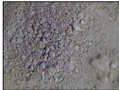
Рис. 4. Осадок смешанного оксида марганца, полученный в одном из опытов, после просушки на воздухе при 80 °C (увеличение в 25 раз)
